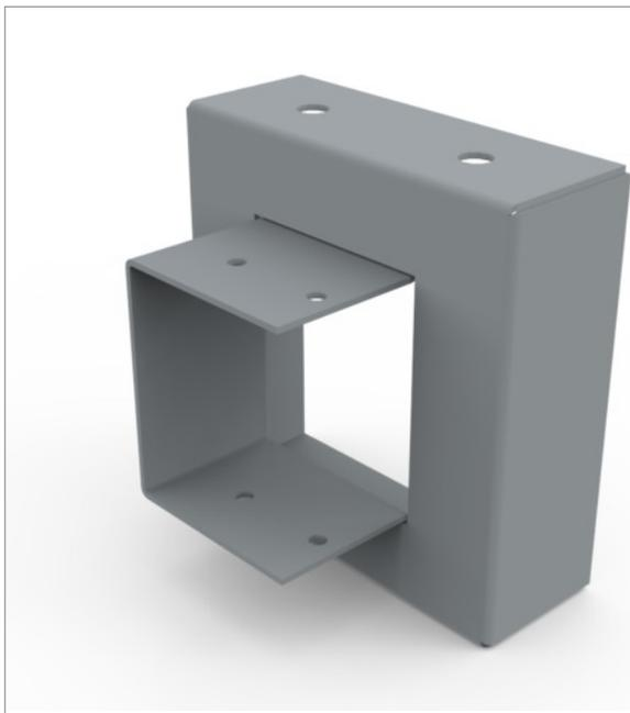
**Peso neto** 0.35 kg**Tipo** Reducción de 4x4" a 3x3"**Material** Acero laminado en frío**Calibre de la lámina** 18**Espesor de la lámina** 1.22 mm**Acabado** Pintura electrostática en polvo**Color** Gris
