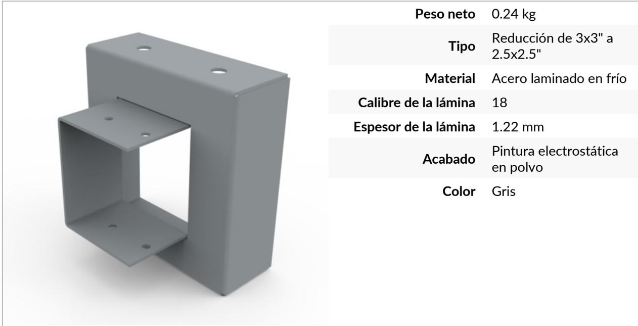
**Peso neto** 0.24 kg**Tipo** Reducción de 3x3" a 2.5x2.5"**Material** Acero laminado en frío**Calibre de la lámina** 18**Espesor de la lámina** 1.22 mm**Acabado** Pintura electrostática en polvo**Color** Gris
